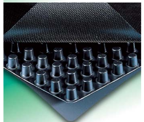
Als Dränschicht werden bei begrünten und genutzten Dächern und Decken häufig Noppenbahnen mit aufkaschiertem Filtervlies (Geoverbundstoffe) oder Noppenplatten aus Kunststoff so genannte Eierbecher (Geospacer) eingesetzt. Die Fotos zeigen CE-markierte Kunststoffdränagebahnen Typ „Nophadrain“.
